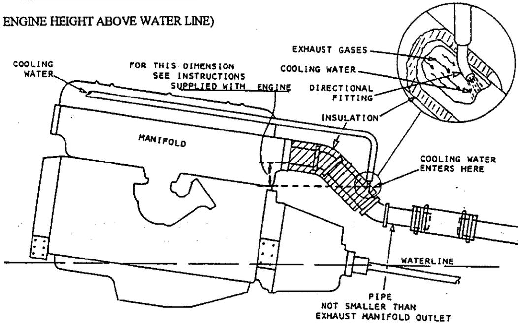
**FIGURE 2 - TYPICAL RISER SYSTEM**
